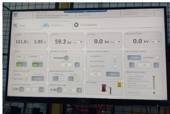
Gambar 3.7 Proses Pengujian Tegangan Flashover
