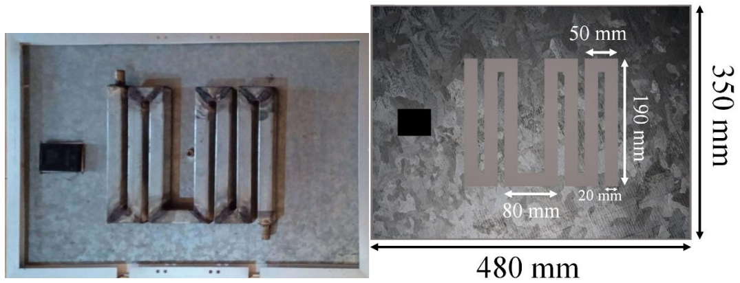
Gambar 3.8 Bagian Bawah Panel Surya dengan Pipa 4, Asli (kanan) dan 3D Model (kiri)
