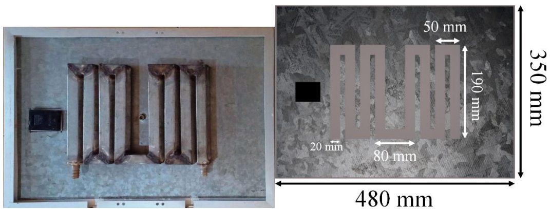
Gambar 3.9 Bagian Bawah Panel Surya dengan Pipa 5, Asli (kanan) dan 3D Model (kiri)
