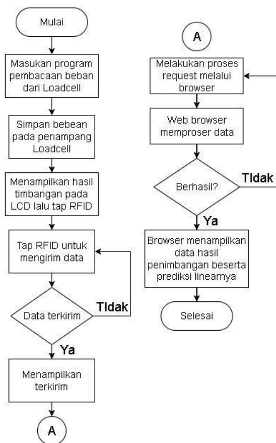
Gambar 3. 9 Flowchart pengujian pembacaan berat dan ditampilkan pada LCD dan Web
