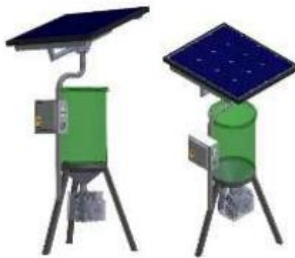
Gambar 2. 2 Desain alat penebar pakan ikan Sumber: (Aris Risnandar et al., 2021)
