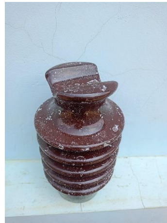
Kondisi Isolator Kering NaCl
