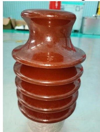
Kondisi Isolator Kering MgCl
