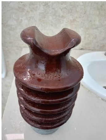
Kondisi Isolator Basah MgCl
