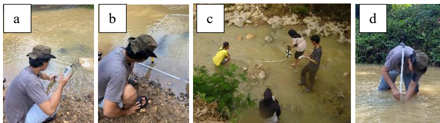
Gambar 3.3 Pengambilan data parameter lingkungan: a) DO dan suhu air, b) pH air, c) kecepatan arus air, dan d) kedalaman air.
