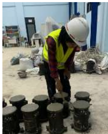
Menghilangkan Gelembung Udara dengan Palu Karet
