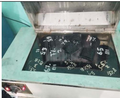
13. Benda Uji dalam Water Bath
