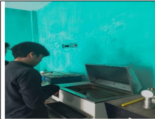
9. Perendaman Benda Uji Dalam Water Bath
