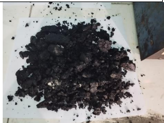
14. Benda Uji sudah Diuji Marshall dan dihancurkan
