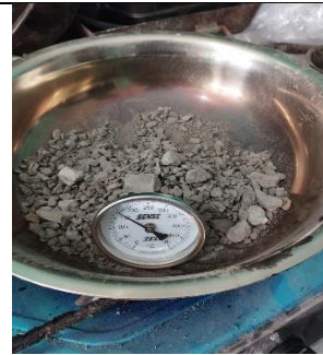
18. Pemanasan Agregat suhu 150°
