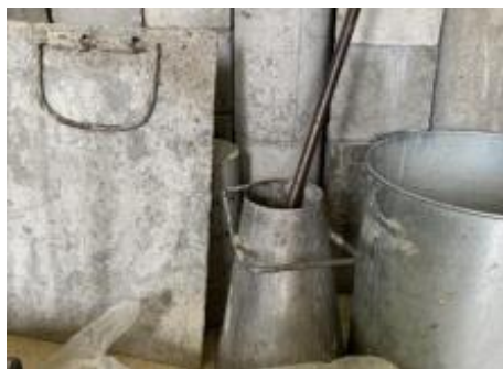
Kerucut Abrams dan Plat Besi
