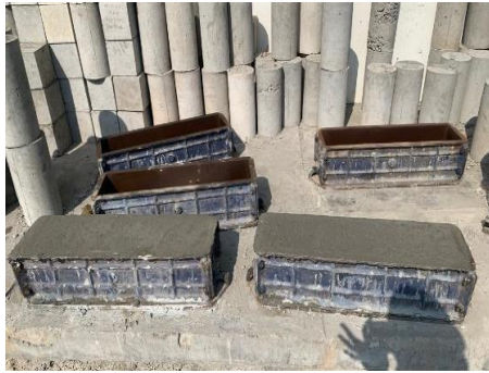
Cetakan Benda Uji
