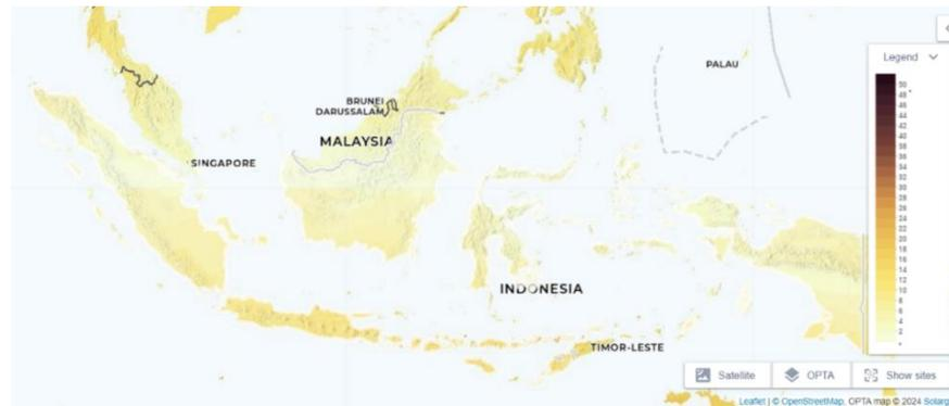
Gambar 2. 5 Kemiringan Optimal PV di Indonesia (Solargis)
