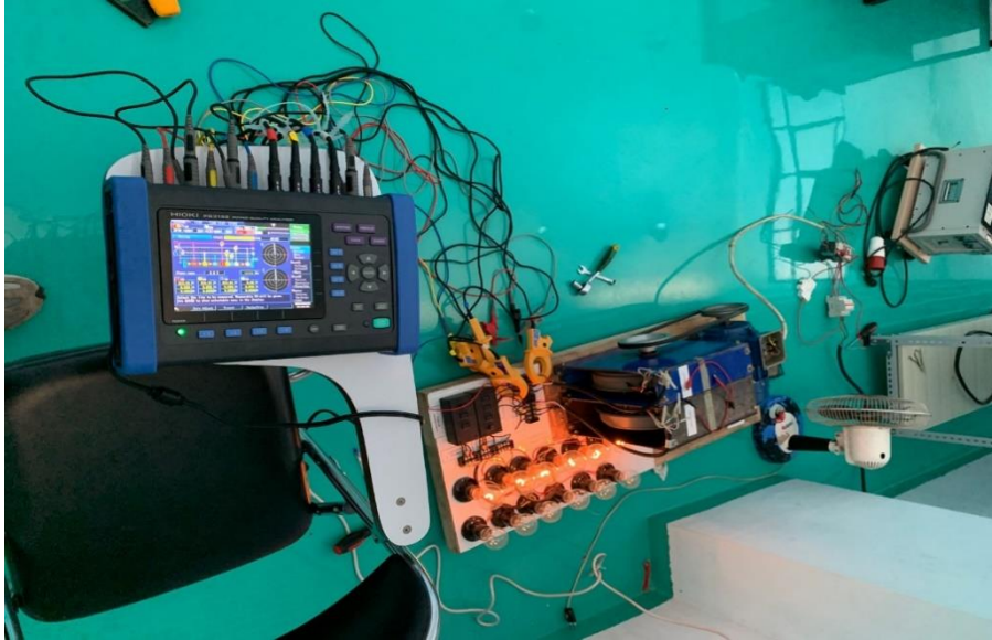
Pengujian Generator PMSG dengan menggunakan PQA (Power Quality Analyzer).
