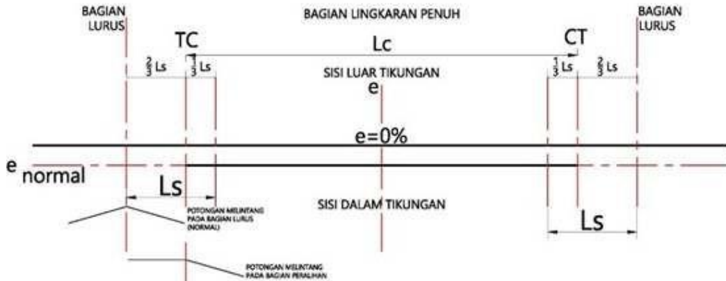
Gambar 2. 17 Diagram superelevasi Full-Circle jika e < 1\% dan > -2\% atau -3\% (NC) nilai e dibulatkan menjadi -2\% atau -3\%
