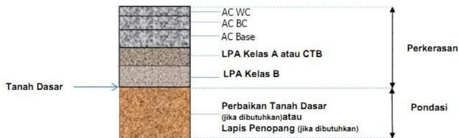
Gambar 2. 27 Susunan Lapisan Perkerasan Lentur
