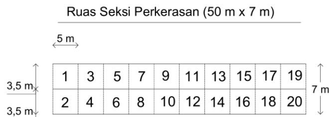
Gambar 3. 6 Pembagian Ruas Perkerasan Kaku Menjadi Unit Sampel per Seksi
