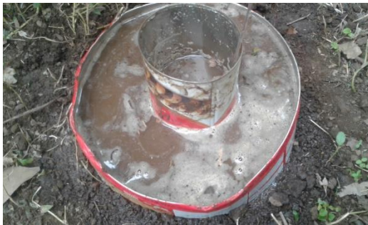
Pengukuran Laju Infiltrasi
