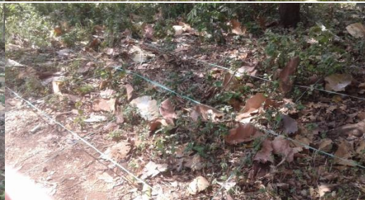
Petak untuk menghitung Batuan Permukaan dan Daerah Pengamatan Singkapan Batuan
