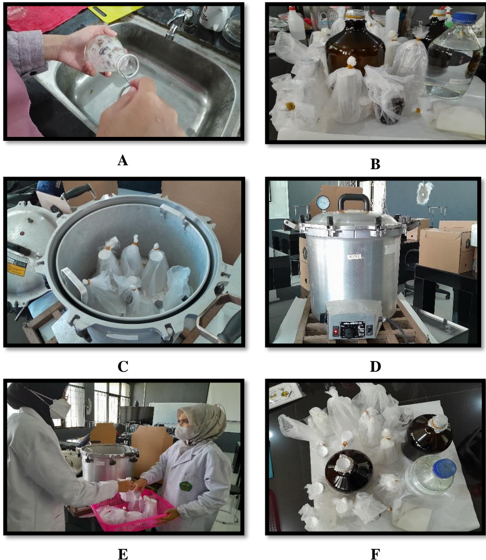
Gambar 3. 2 Proses pencucian alat-alat (A), Proses membungkus alat-alat yang disterilisasi (B), Memasukkan alat dan bahan ke dalam autoklaf (C), Proses sterilisasi menggunakan autoklaf selama 60 menit (D), Proses mengeluarkan dan meniriskan alat dan bahan yang sudah disterilisasi (E), dan Alat dan bahan yang siap digunakan (F)
