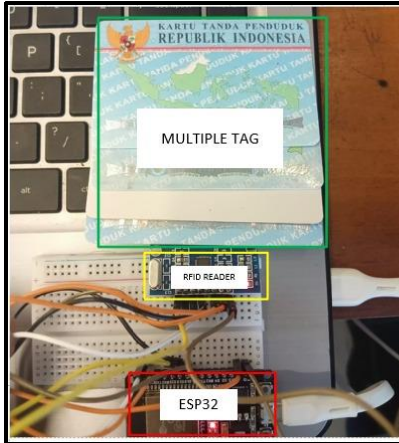
Gambar 3. 18. pengujian Kapasitas Penanganan Multiple Tag terhadap RFID reader
