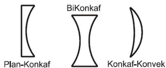
Gambar 2.8 Lensa Divergen/Lensa Negatif
