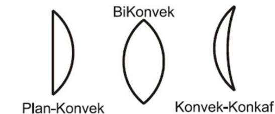
Gambar 2.7 Lensa Konvergen/Lensa Positif
