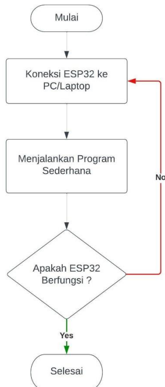
Gambar 3.5. Pengujian Mikrokontroler ESP32
