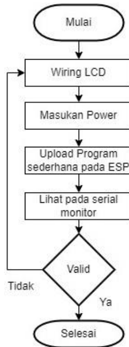
Gambar 3.6 Flowchart pengujian LCD
