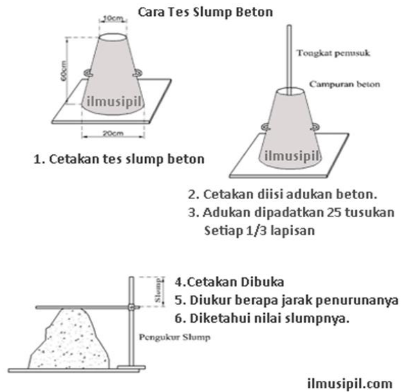
Gambar 2.7 Bentuk hasil pengujian slump
