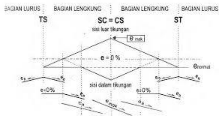
Gambar 2.17 Diagram Superelevasi pada Tikungan SS
