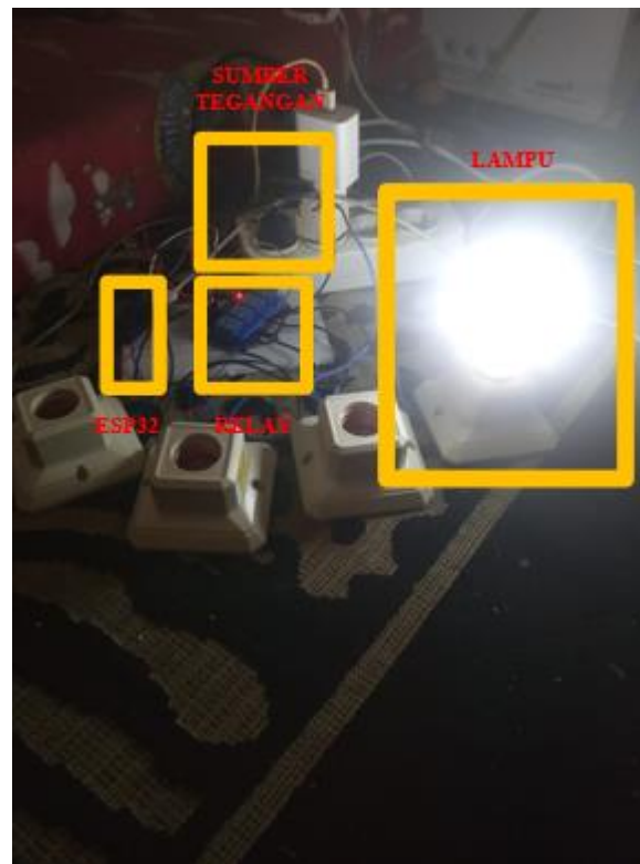
Gambar 3. 9. Rangkaian Pengujian Lampu yang Terhubung ke Sistem Kontrol
