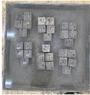
Gambar 4.5 Perendaman Paving Block Dalam Air Selama 24 Jam
