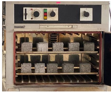
Gambar 4.6 Pengeringan Paving Block Dalam Oven Selama 24 Jam
