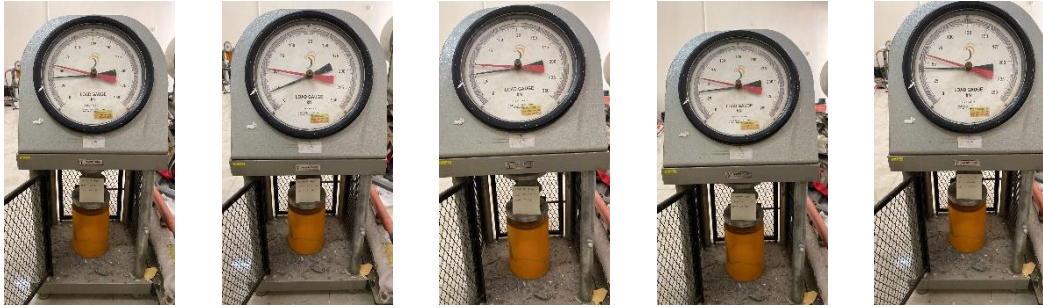
Pengujian kuat tekan paving block variasi penambahan 8% umur 28 hari
