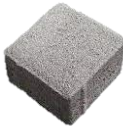
Gambar 2.3 Paving block setelah dipotong
