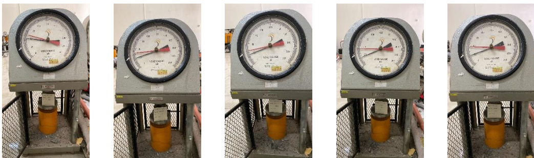
Pengujian kuat tekan paving block variasi penambahan 12% umur 28 hari
