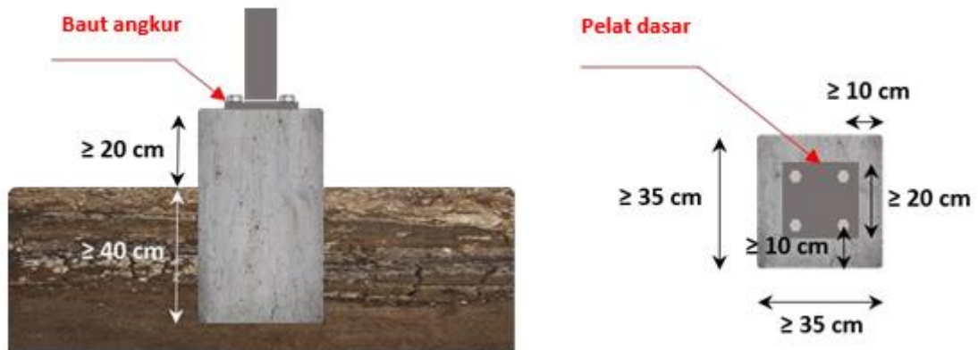
Gambar 2. 18 Ukuran pondasi yang disarankan
