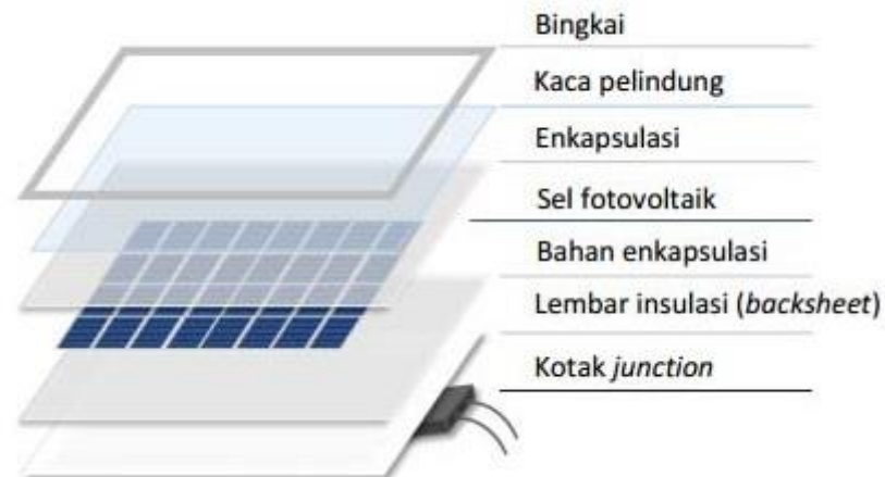
Gambar 2. 16 Struktur Panel Surya
