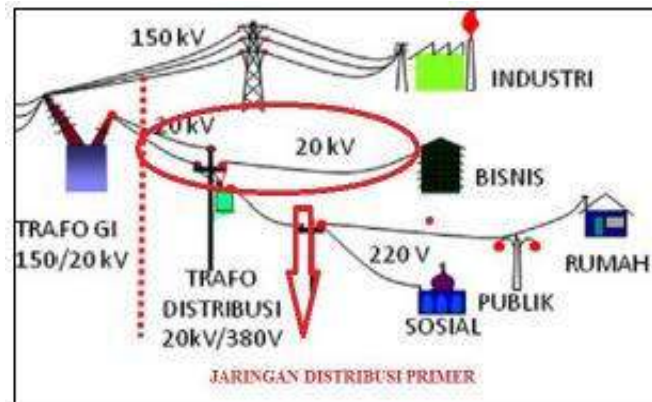
Gambar 2.3 Jaringan Distribusi Primer (Hardianto 2017)
