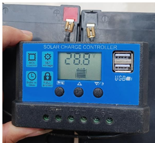
Gambar 3. 23 Pengaturan Float Voltage
