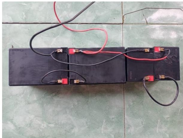
Gambar 3. 14 Hasil Wiring Seri dan Paralel Baterai
